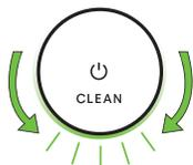
Amikor a robot érzékeli, hogy a portartályt ki kell üríteni, a fénygyűrűs kijelző pirosan világít a hátsó rész felé irányuló törlő mozdulatokkal.
