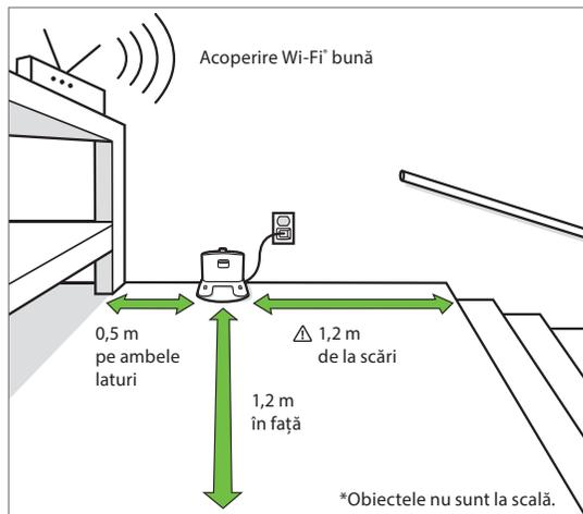
**⚠️ AVERTISMENT:** Pentru a preveni riscul căderii pe scări a robotului dvs., asigurați-vă că stația de încărcare Home Base este amplasată la cel puțin 1,2 metri de la scări.
