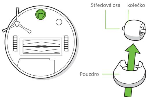
**\* Důležité:** Přední kolečko zanesené chlupy a nečistotami může poškodit podlahu. Pokud se kolečko po čištění volně netočí, kontaktujte oddělení péče o zákazníky.
