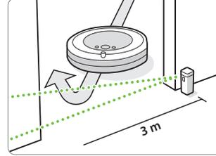
**Not:** Bu bariyer cihazdan uzaklaştıkça genişler (şekle bakın).
