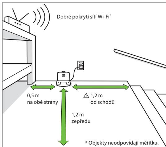
**!** **VAROVÁNÍ:** Abyste zabránili riziku pádu robota ze schodů, ujistěte se, že se nabíjecí stanice nachází nejméně 1,2 metru od schodů.
