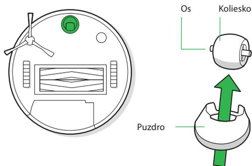
**\* Dôležité:** Zablokovanie predného kolieska nečistotami by mohlo mať za následok poškodenie podlahy. Ak sa koliesko ani po vyčistení neotáča voľne, kontaktujte oddelenie starostlivosti o zákazníkov.
