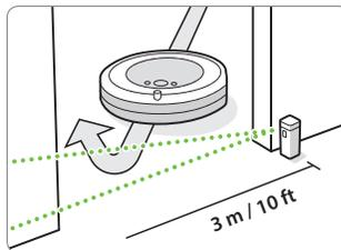
**Σημείωση:** Το πλάτος του φράγματος γίνεται μεγαλύτερο καθώς απομακρύνεται από τη συσκευή (ανατρέξτε στην εικόνα).
